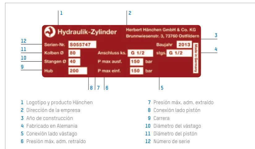
Figura 1: Placa de características del cilindro hidráulico
